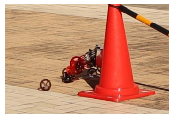
タイヤ破損の瞬間
