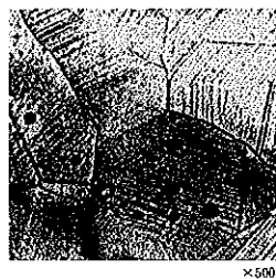
図1-6 黄銅の表面にあらわれたすべり線 (S.H. Avner)
