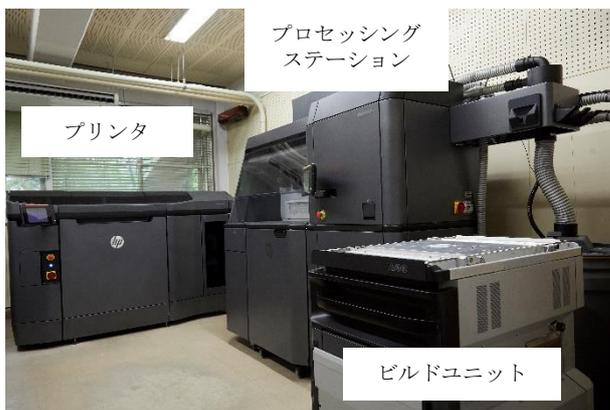
HP JF4200 はプロセッシングステーション、プリンタ、ビルドユニットから構成されています。プロセッシングステーションは原料であるパウダー状の樹脂の準備と充填、造形物の取り出しおよびリサイクル用に造形後の樹脂の回収などを行いません。プリンタはビルドユニットを用いて HP Multi Jet Fusion テクノロジーにて造形を行います。ビルドユニットは原料粉末を格納し、プラットフォーム上に造形物が作製されます。
